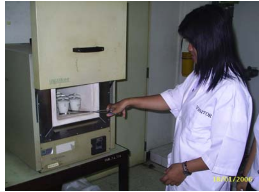
ภาพที่ 8. การเผาตัวอย่างกะปิในเตาเผา เพื่อหาปริมาณเถ้า
