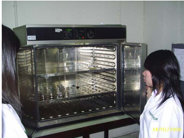
ภาพที่ 9. การวิเคราะห์หาความชื้นในกะปิโดยใช้ตู้อบ
