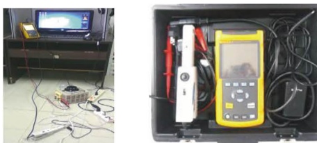
ภาพที่ 5 การวัดค่าอัตราการใช้พลังงานไฟฟ้า และคุณภาพทางไฟฟ้าของจอภาพ และเครื่องมือวัดที่ใช้
