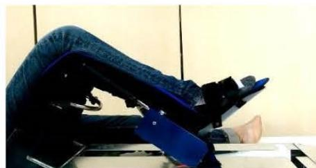
ภาพที่ 18 ทดสอบการสวมใส่อุปกรณ์ที่ตำแหน่งเหยียดสุด
