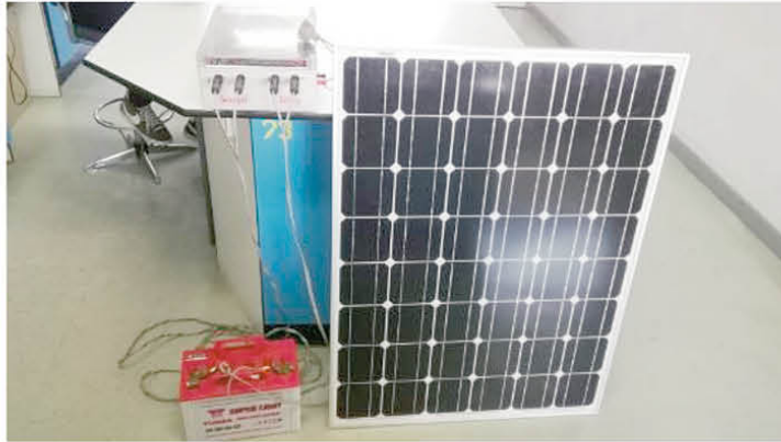
ภาพที่ 4 การต่อร่วมกับชุดผลิตกระแสไฟฟ้าด้วยเซลล์แสงอาทิตย์
