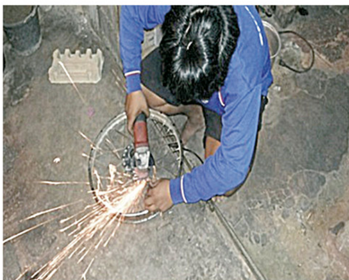
ภาพที่ 4 ทำการเจาะรูยึดใบกังหันและเพื่อลดน้ำหนักในส่วนของกังหัน
