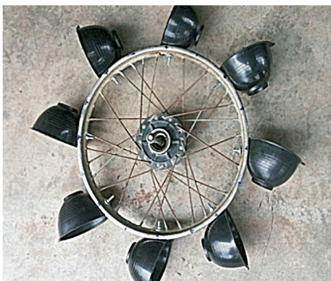
ภาพที่ 5 ทำการยึดใบกังหันและเพื่อทดสอบการทำงานของกังหันน้ำ
