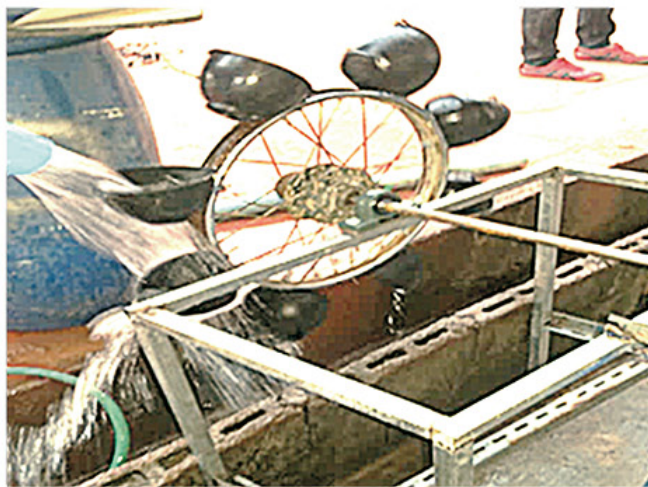
ภาพที่ 6 ระบบการทดสอบการผลักกังหันน้ำโดยใช้พลังงานน้ำ
