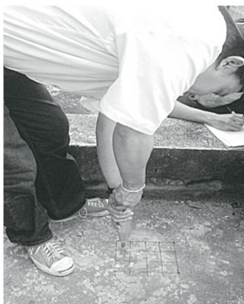
ภาพที่ 3 การทดสอบกำลังอัดของคอนกรีตด้วยค้อนกระแทก (Schmidt hammer)
