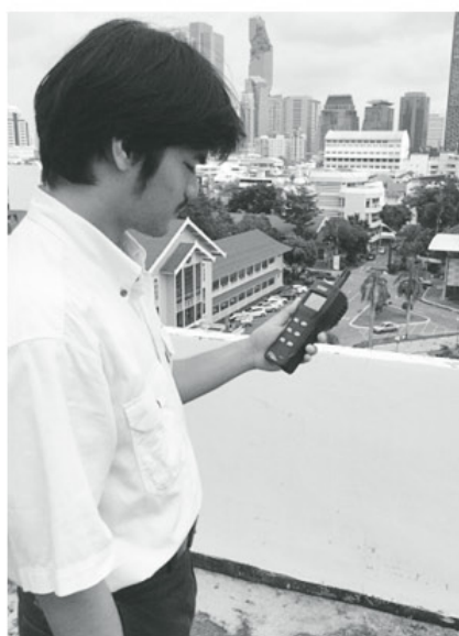
ภาพที่ 2 การวัดปริมาณก๊าซคาร์บอนไดออกไซด์และความชื้นสัมพัทธ์บนตาดฟ้าอาคาร
