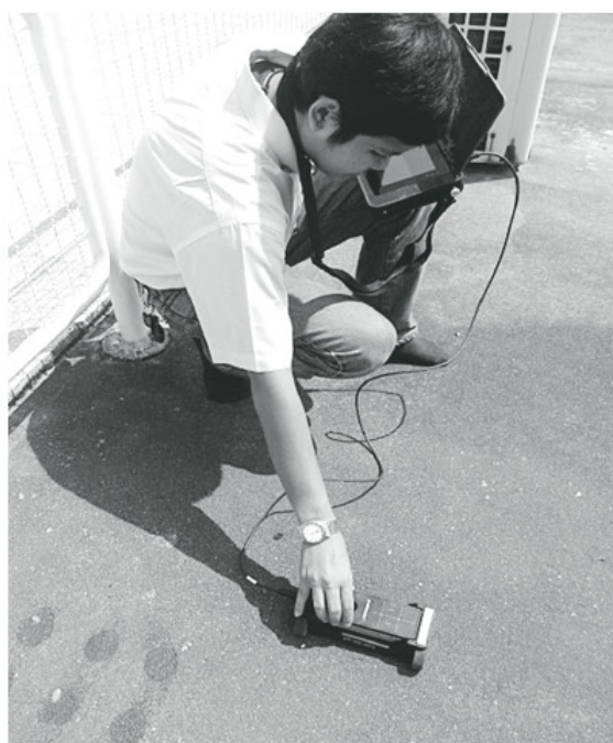
ภาพที่ 5 การหาตำแหน่งของเหล็กเสริมและระยะหุ้มคอนกรีต
