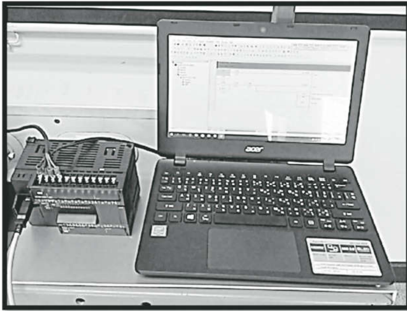
ภาพที่ 4 ชุด PLC และอุปกรณ์เขียนคำสั่ง
