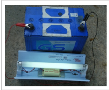
ภาพที่ 5 การติดตั้งชุดโคมไฟฟ้า
